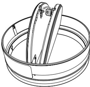
3. Encliquez le fusible dans le support pour verrouiller les lames.
