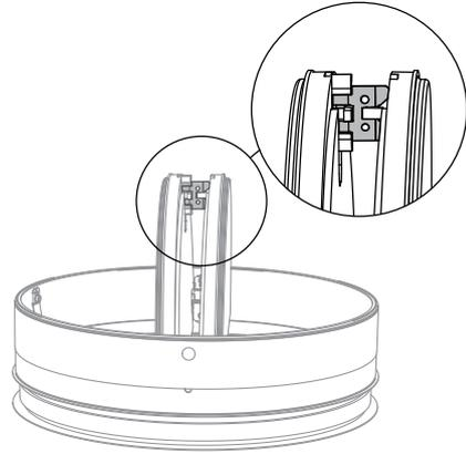
2. Déclenchez (fermez) les lames en les poussant l'une vers l'autre et en exerçant une pression légère sur le fusible.
